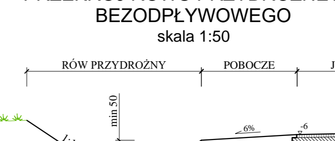
PRZEKRÓJ ROWU PRZYDROŻNEGO, BEZODPŁYWOWEGO skala 1:50
