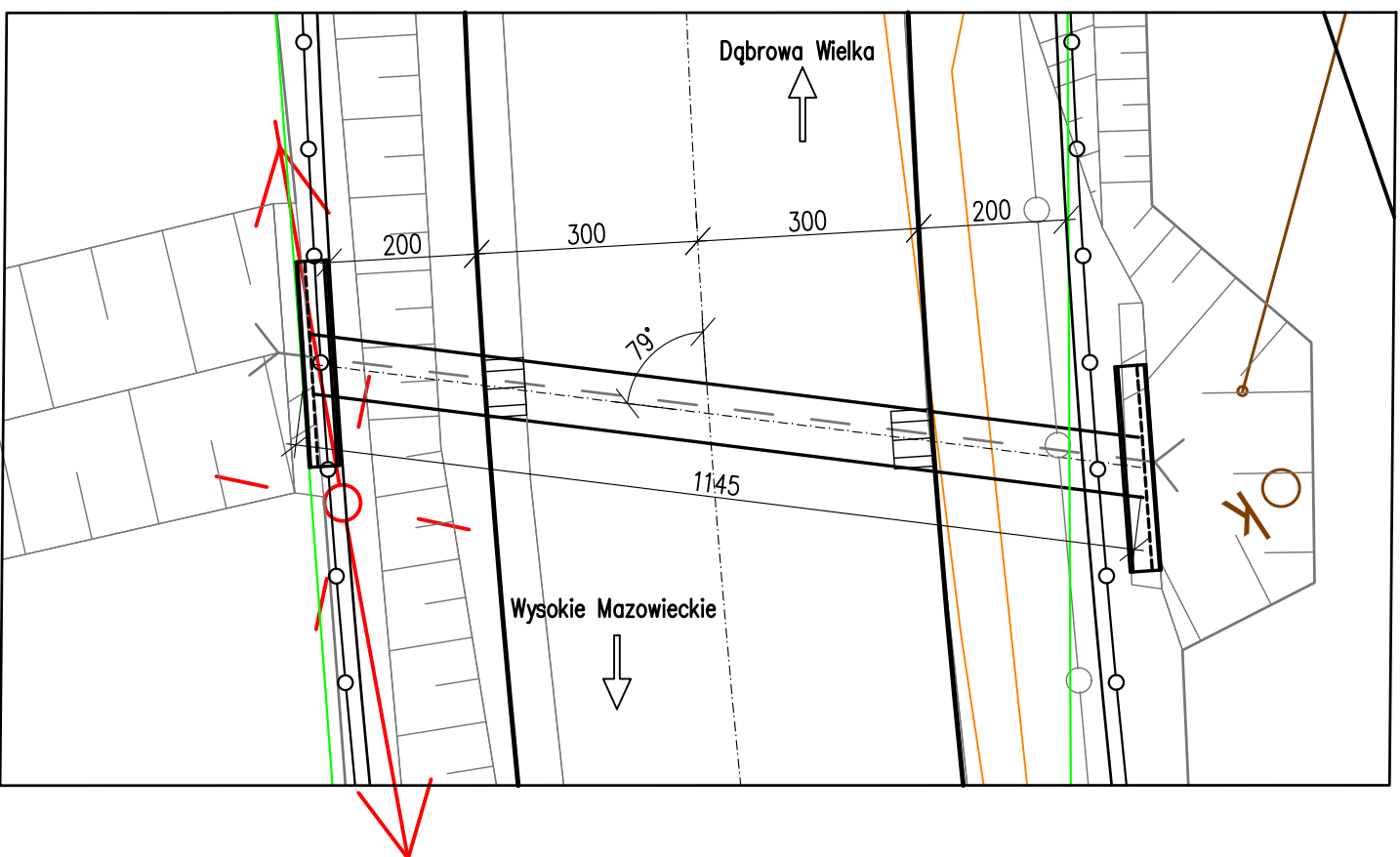
WIDOK Z GÓRY PRZEPUSTU P5 Ø80 km 3+725,00 skala 1:100
