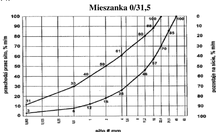
Rys. 1. Uziarnienie mieszanki CBGM 0/31,5
